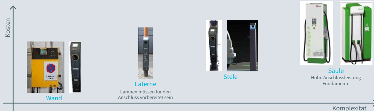
Bauformen öffentlicher Ladeinfrastruktur
