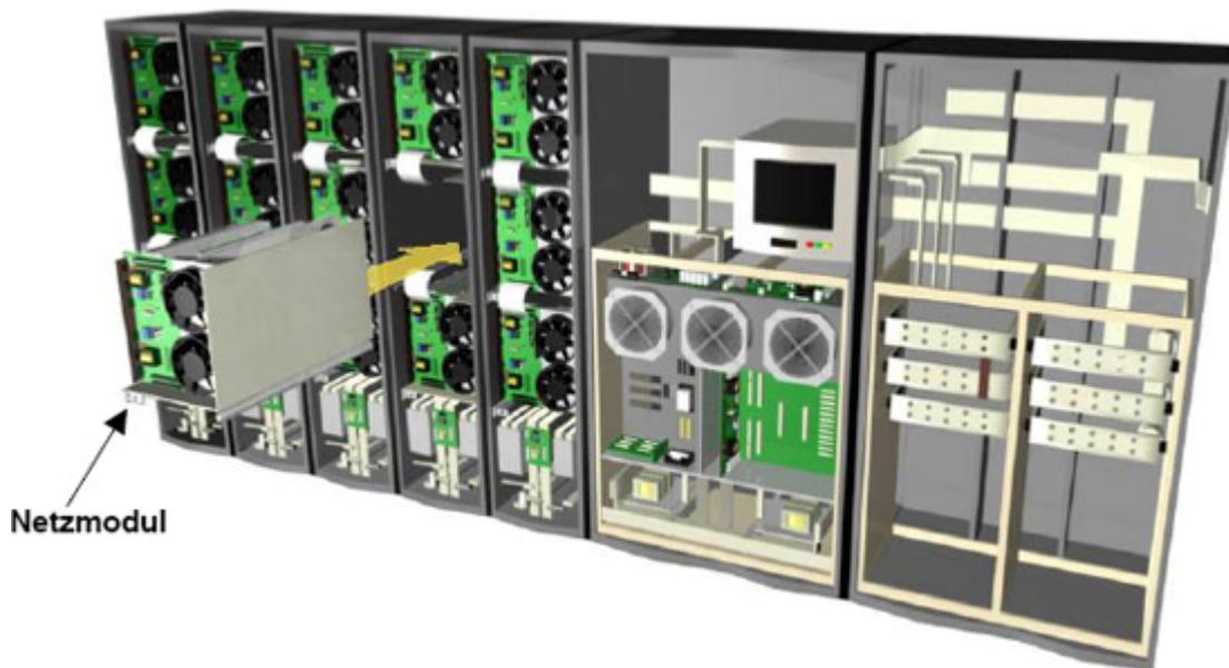
einer besseren elektrischen Effizienz durch die Anpassung der USV-Leistung an die jeweilige Last, bietet ein modularer USV-Aufbau weitere Vorteile, die sich positiv auf Verfügbarkeit, Flexibilität und TCO auswirken. Eine ausführliche Beschreibung dieser Vorteile kann dem APC White Paper Nr. 116, „Standardisierung und Modularität in der physikalischen Infrastruktur für hochverfügbare Netzwerke“ entnommen werden.
