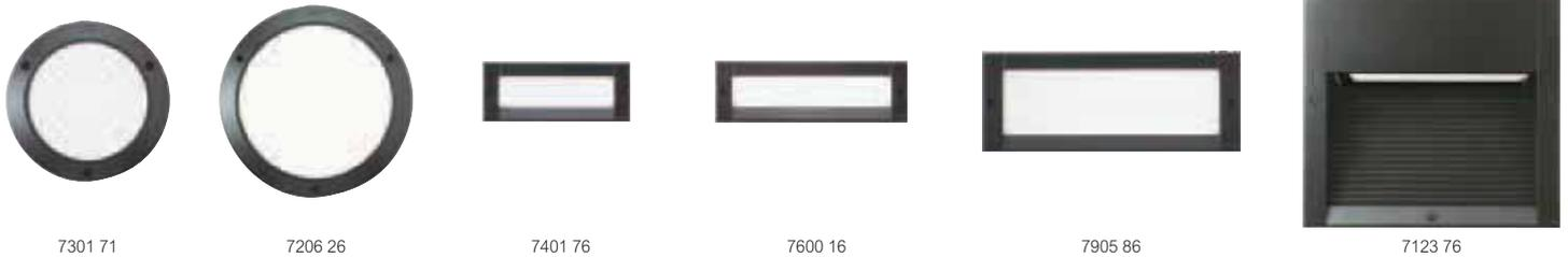
Außenleuchte vandalensicher, strahlwassergeschützt. Schlagfeste Leuchte für Wand- und Deckenmontage im Außenbereich, der gegen Vandalismus bzw. starke Beanspruchung geschützt werden muss. Vandalensicherheit durch Spezialdichtung zwischen Mauerwerk und Leuchte, schlagfeste Abdeckung aus Polycarbonat, massivem Unterteil aus Aluminium und Fixierung des Oberteils mittels unverlierbarer Spezialschrauben.
