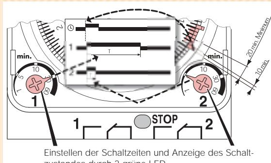
Einstellen der Schaltzeiten und Anzeige des Schaltzustandes durch 2 grüne LED.
