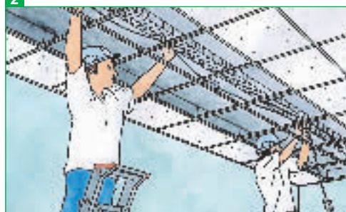
2 Installation von Canalis KDP
