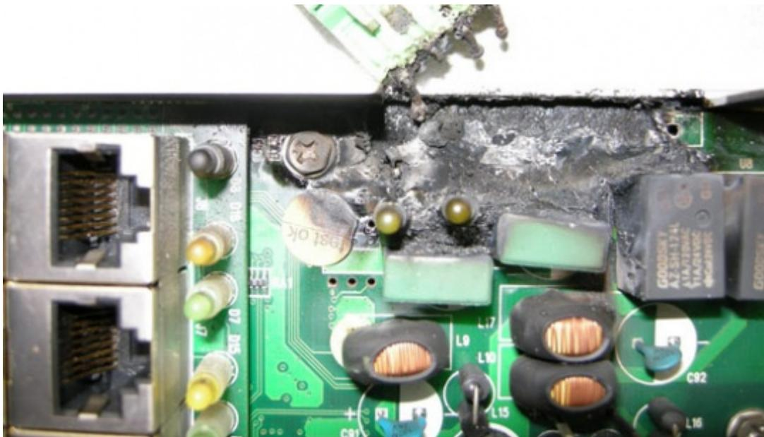
Eine dauerhaft anliegende Überspannung zeigt deutliche Überlastungen der Elektronik und Brandspuren auf einer Switch-Platine (Bild 4b)
