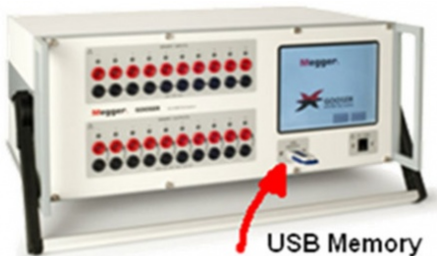
Abbildung 10: GOOSER kann im Stand-alone-Modus, nur mit einem USB-Speicher, laufen
