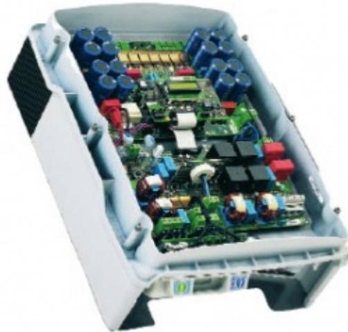
Bild 4: Sunny Mini Central 8000TL für dezentrale Konzepte
