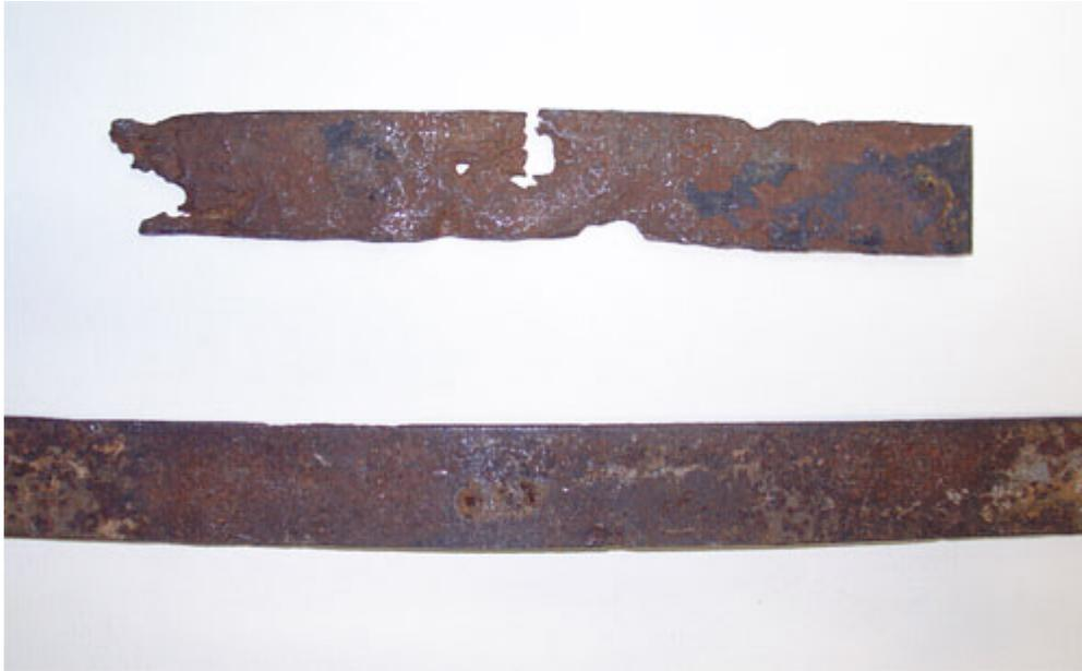
Bild 1: Korrosion an Oberflächenenerdern
