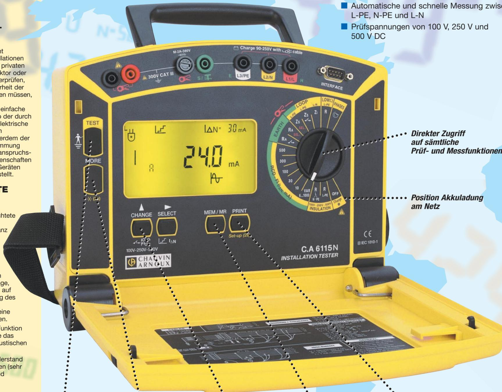
Direkter Zugriff auf sämtliche Prüf- und Messfunktionen
