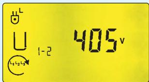
Schließen Sie die 3 Phasen an und lesen Sie die Phasenlage ab: kann es noch einfacher gehen?
