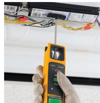
Einfache Funktionsprüfung des Vorschaltgerätes
