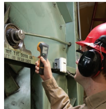
Drehzahlerkennung mit Stroboskopdiagnose
