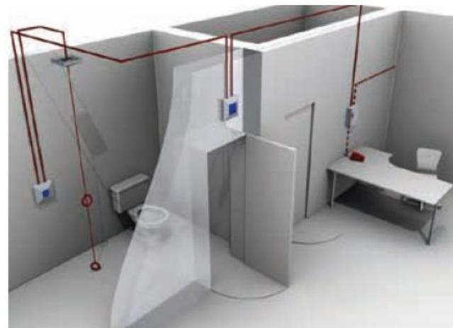
Kit de alarma de asistencia de emergencia independiente, esquema de uso básico
