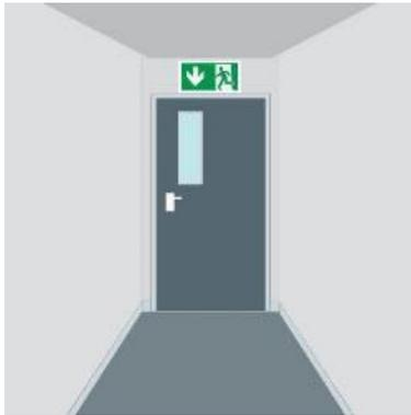
En el funcionamiento normal, la **iluminación uniforme** de los pictogramas facilita la identificación de salidas de emergencia.
