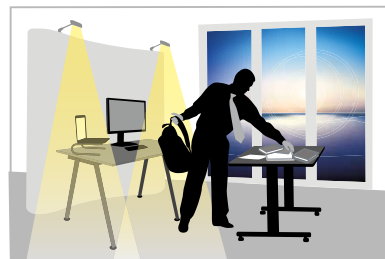
Con poca luz y con la detección del movimiento, el 18.51 enciende automáticamente las lámparas.
