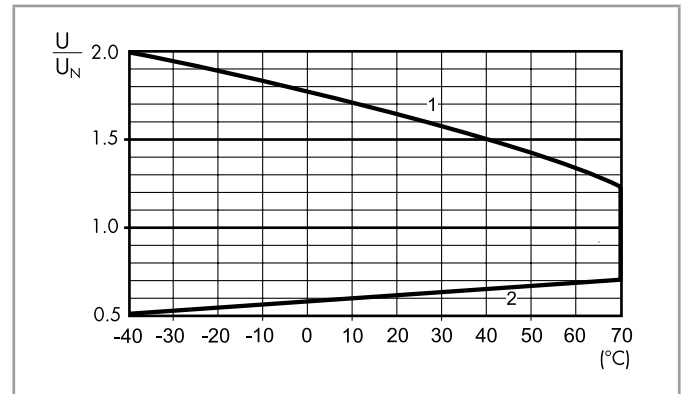
R 55 - Campo de funcionamiento de la bobina DC en función de la temperatura ambiente
