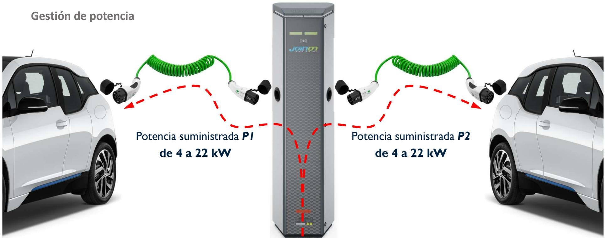
Sección de línea alimentación del punto de recarga dimensionada para 44 kW
