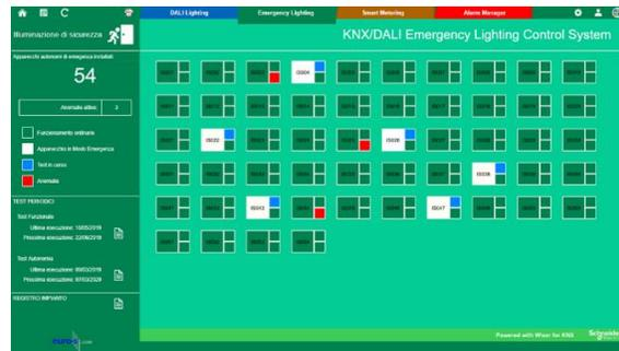
Todo el sistema de iluminación se controla digitalmente con una arquitectura KNX/DALI. El área de producción está equipada con 15 sensores de movimiento y luminosidad para grandes alturas (GWA9532) que permiten el control autónomo de otras tantas zonas.
