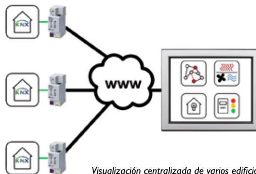
Visualización centralizada de varios edificios descentralizados
