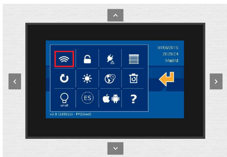
Imagen 14. Configuración inalámbrica de la pasarela KNX desde la pantalla virtual.
