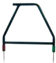
Arco A-Frame Para determinar la posición del defecto del cable
