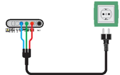
Puenteando el conductor de protección con el conductor de fase o el neutro en el cuadro general
