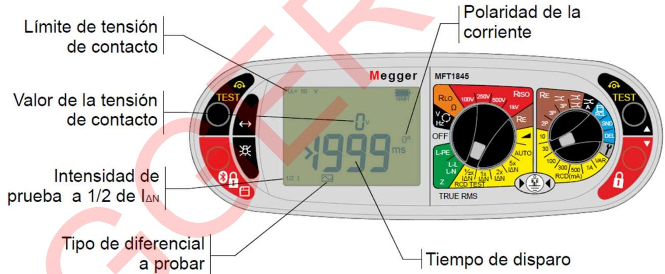
Al realizar la prueba del tiempo de disparo del diferencial a  $\frac{1}{2}$  de la  $I_{\Delta}$ , el equipo comprobará la resistencia de tierra  $R_E$  en base a ello indicará la tensión de contacto ( **$U_C$  o  $U_L$** )
