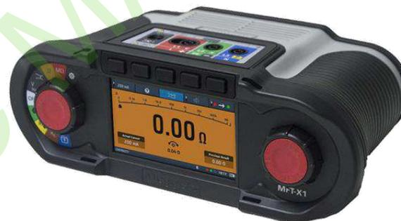
Un **equipo multifunción** es capaz de inyectar **corrientes de 200 mA** para realizar esta verificación
