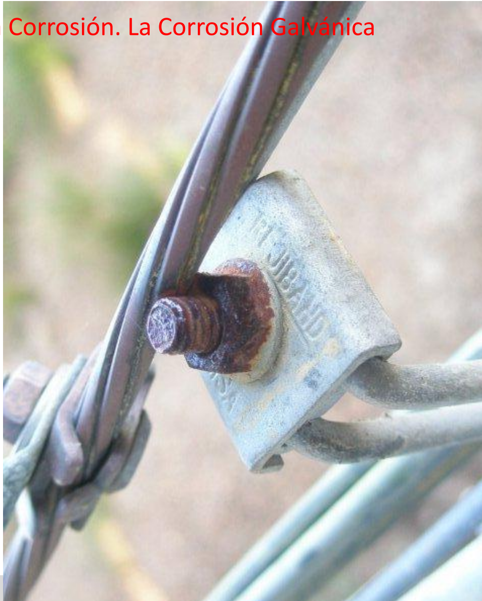
Cable de Cobre desnudo con accesorio GC en ambiente extremo
