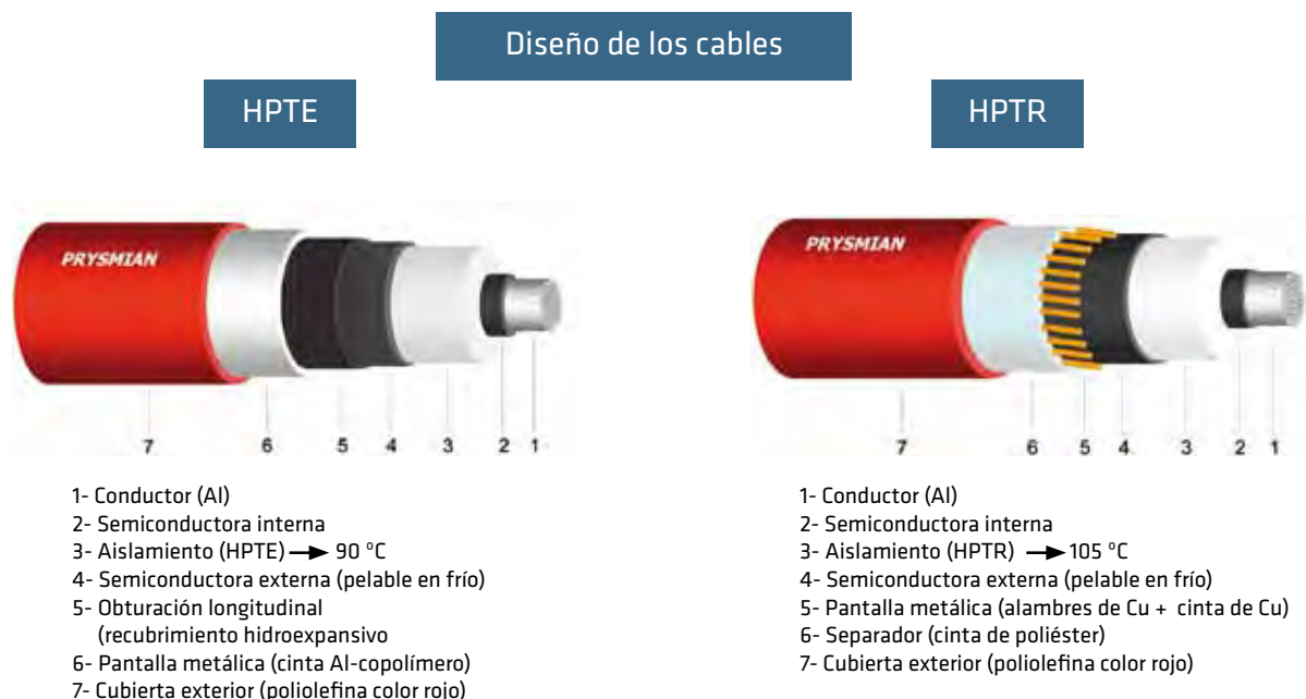
Estructura de los dos tipos de cable P-Laser
