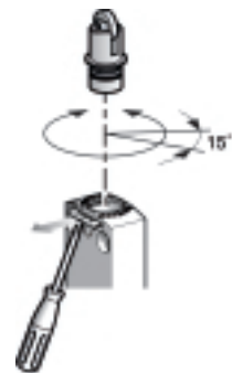
Todas las cabezas se pueden ajustar de 15° en 15° sobre 360° con respecto al cuerpo.
