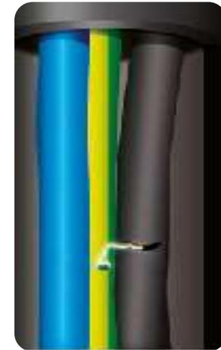
Contacto entre una fase y la protección en el conductor.
