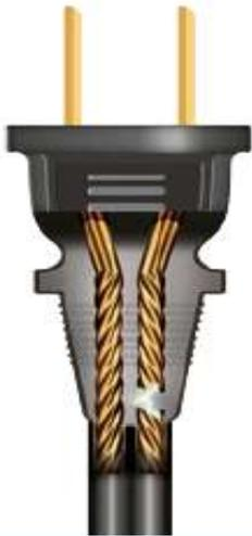
Rotura de un conductor.
