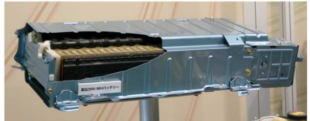
Foto 6.2. Fotografías del Prius, vehículo eléctrico híbrido comercializado por la empresa japonesa Toyota, y de su sistema de baterías alcalinas de níquel-hidruro metálico.
