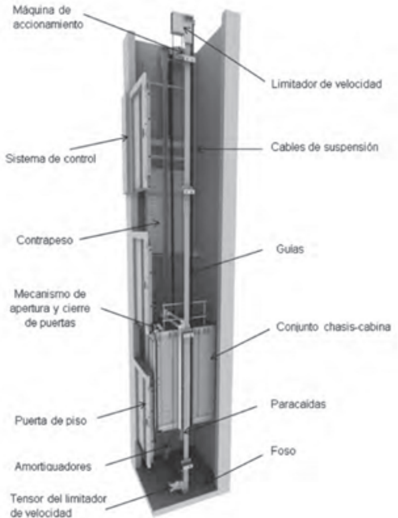
Figura 2. Instalación de un ascensor eléctrico. Fuente: Orona.
