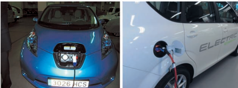
Figura 5. Vehículos para recarga en modo 3 con toma tipo 1 y tipo 2.
