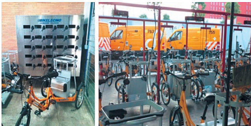
Figura 5. Modelo de nicho de carga (izquierda) y sistema de carga in situ (derecha).
