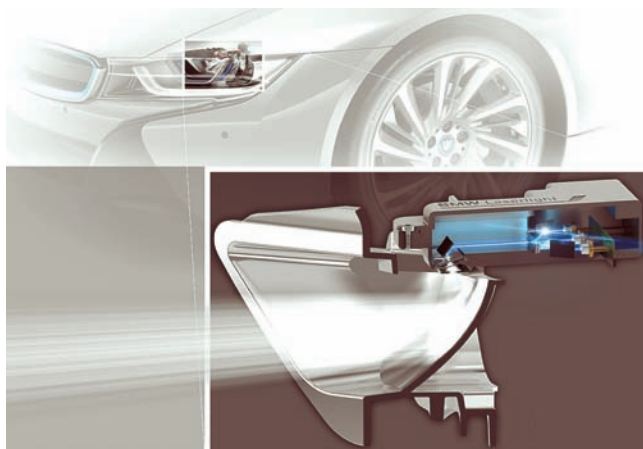
Figura 1. BMW Laserlight . Avanzada técnica de iluminación no dañina para el ojo humano. Diodos hasta diez veces más pequeños, ahorran peso y son capaces de alumbrar hasta 600 m aproximadamente.
