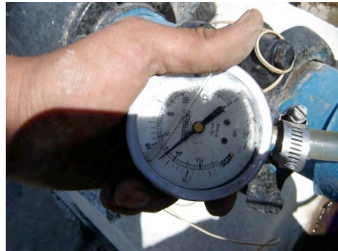
FOTOGRAFÍA 5.1 Medición de presión con manómetro tipo Bourdon calibrado
