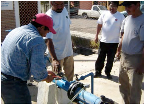
FOTOGRAFÍA 5.1 Medición de presión con manómetro tipo Bourdon calibrado
