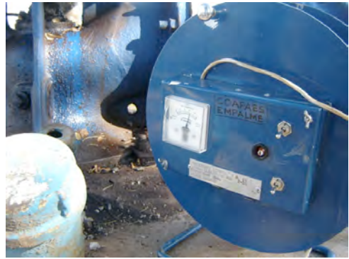
FOTOGRAFÍA 5.2 Medición del nivel dinámico de succión en cárcamos de bombeo
