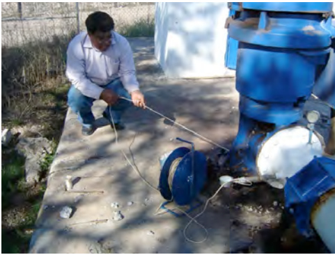
FOTOGRAFÍA 5.2 Medición del nivel dinámico de succión en cárcamos de bombeo
