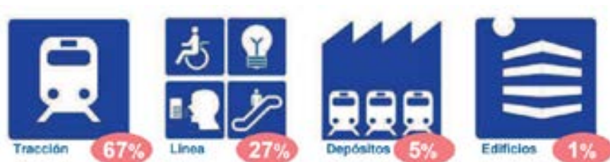
Figura 6.3. Gastos energéticos. Fuente: Metro de Madrid.
