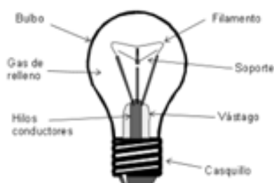
Figura 2.13. Esquema de una lámpara incandescente.
