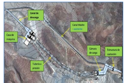
Obras que integran el proyecto
