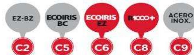
Clasificación resistencia a la corrosión según UNE-EN 61537
