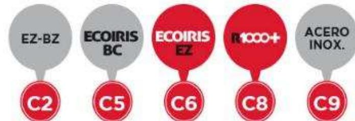
Número de horas en ensayo de niebla salina neutra (NSS) según ISO 9227, sin que se produzca la aparición de óxido rojo (<5% de la superficie total).
