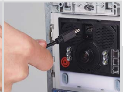
4 Realizar las regulaciones necesarias y configurar con PC
