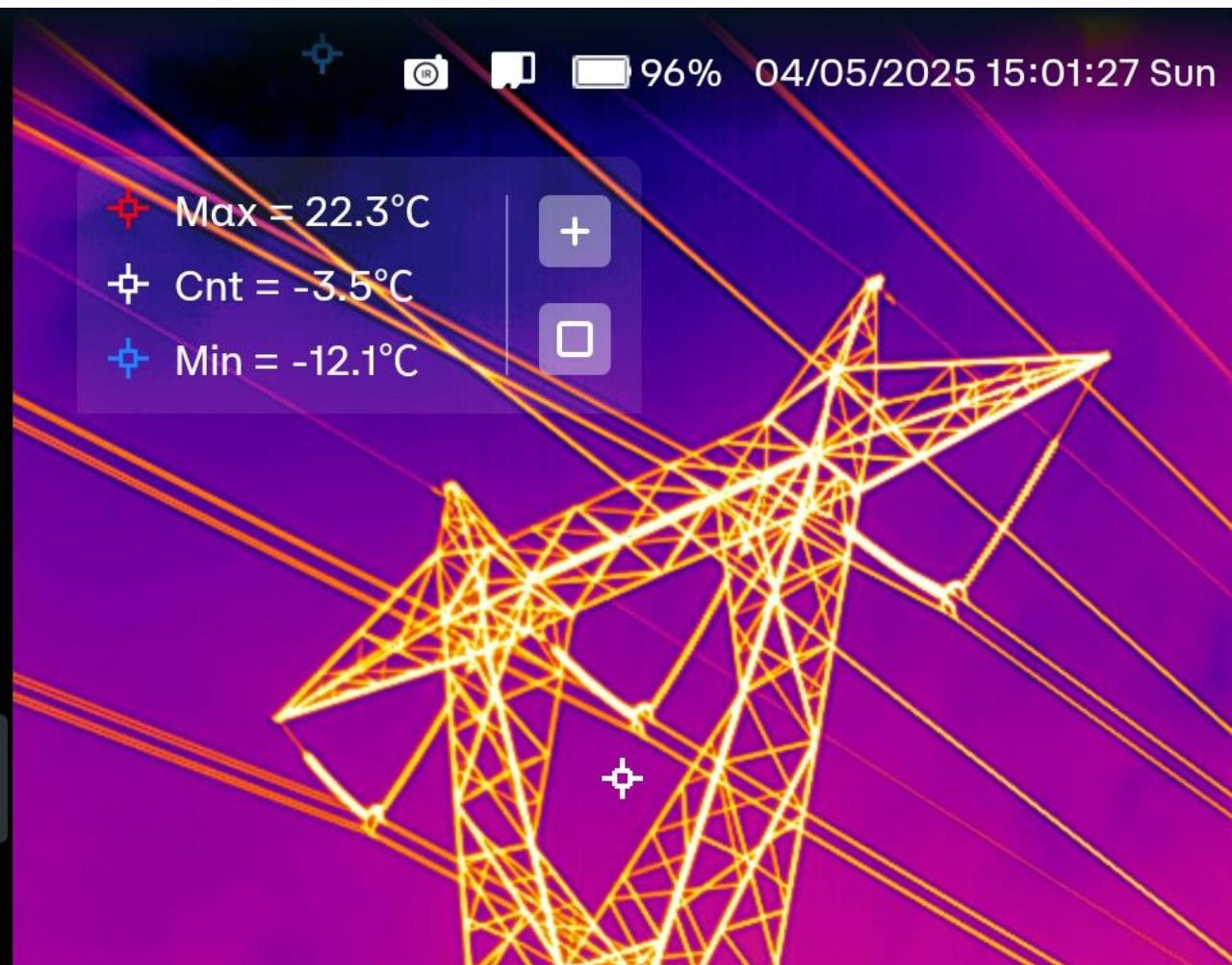
**DETECCION DE DEFECTOS A LARGA DISTANCIA COMBINADO CON TERMOGRAFIA**
