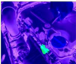
Luz ultravioleta para detección de fugas
