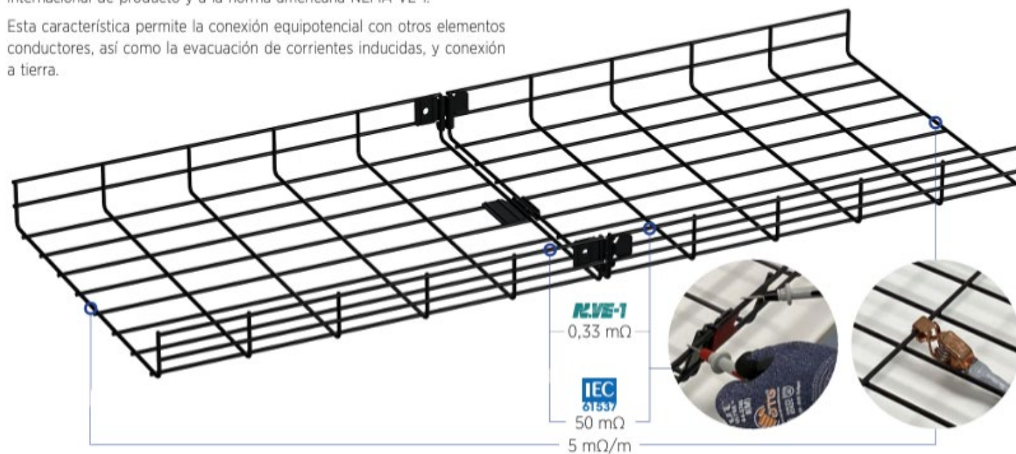
Fig. 3: Esquema de los ensayos de Conductividad eléctrica según norma IEC 61537
