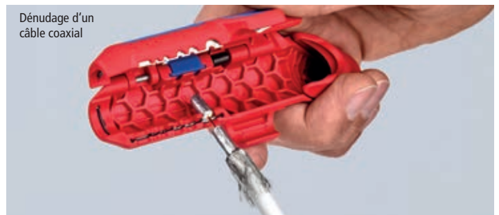
Dégainage d'un câble de données
