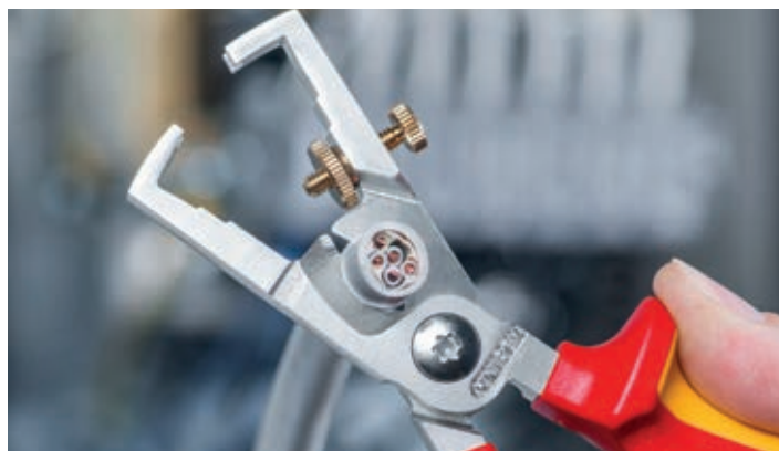
Repères de longueur : Repères visuels aidant au dénudage répété de longueurs usuelles (11 et 16 mm)
