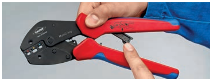
Replier le levier et refermer la pince : prêt pour sa prochaine utilisation
