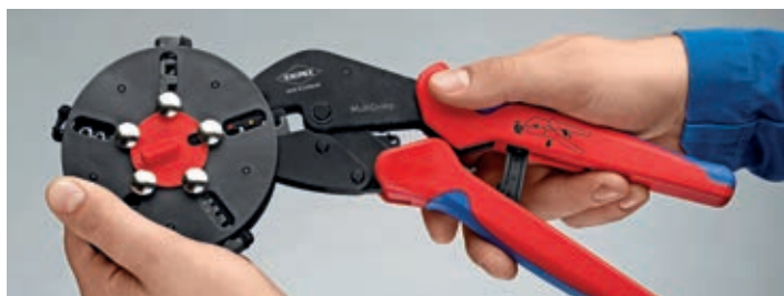
Changement du profil de sertissage : déverrouiller la position du magasin, extraire le profil de la pince
