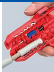
Dégainage d'un câble NYM
