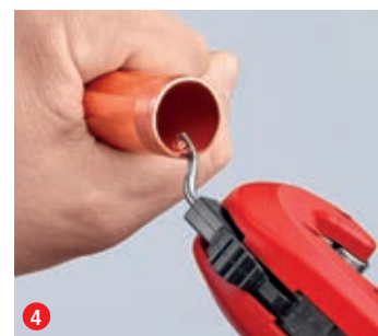
4 et voilà ! Au besoin, lissez l'arête de coupe avec l'outil d'ébavurage escamotable, avec étonnamment peu d'effort
