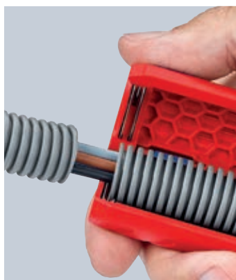
Arête de coupe propre et aucun dommage sur le câble à l'intérieur car la coupe s'effectue toujours sur la tranche du haut
