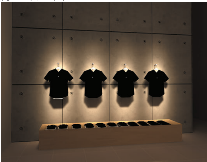
(figure 2.1.2) Quatre projecteurs avec lentille et faisceau de 12° sur mur
