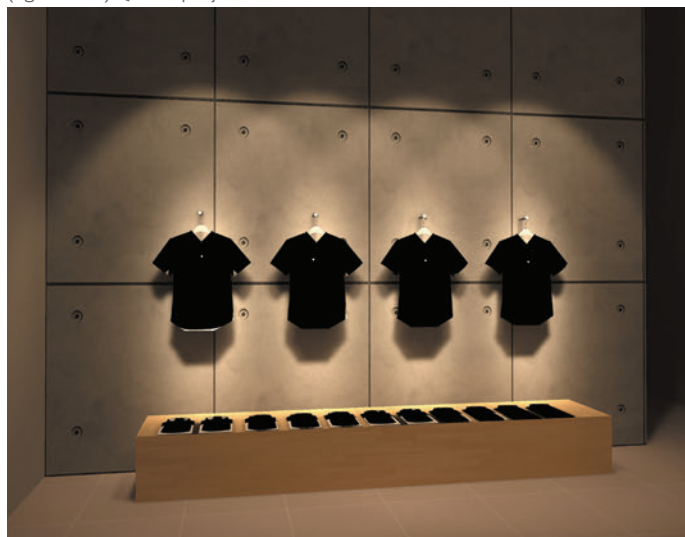
(figure 2.1.2) Quatre projecteurs avec réflecteur et faisceau de 12° sur mur
