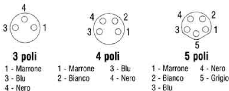
Fig.26a: Configurazione numero poli e conduttori. Connettori circolari diametro M8
