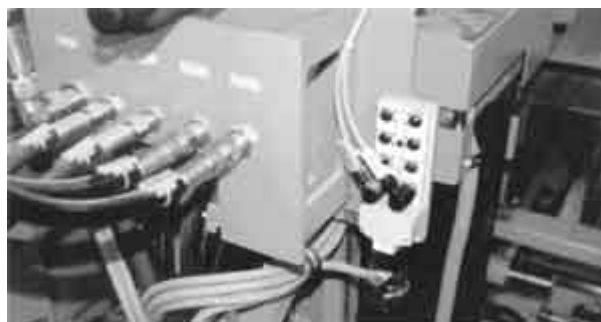
Fig.37b: Esempi di applicazione di interfacce per sensori e attuatori installate sul bordo macchina
