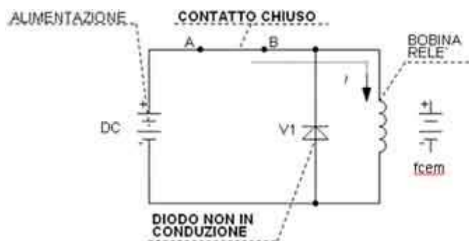
Fig.33: Principio di funzionamento del diodo di ricircolo
