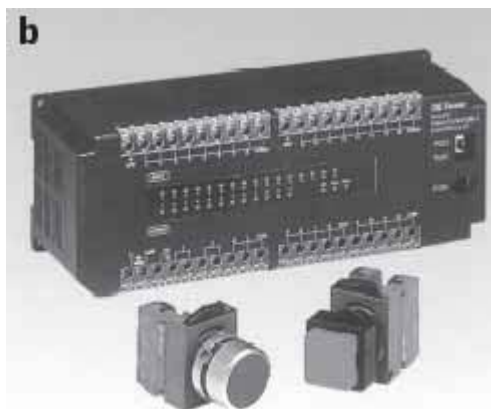
Fig.17b: I pulsanti possono essere utilizzati per fornire dei segnali di comando ai controllori logici programmabili (GE)
