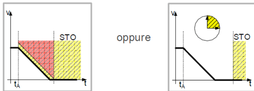
Figura 5 - Funzione di sicurezza Safe Stop 1 (categoria 1)
