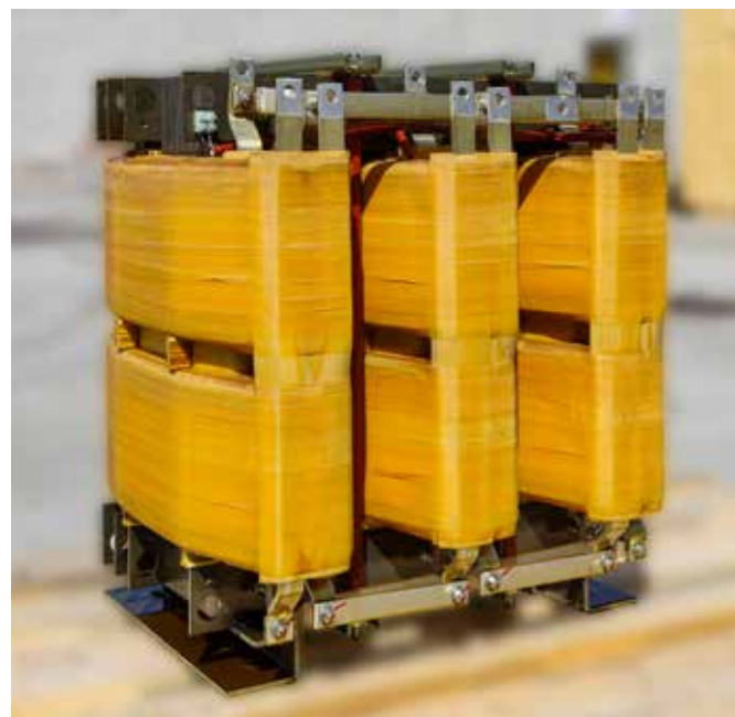
Trasformatore di isolamento trifase Dd0y11 60 kVA con induttanza integrata.
