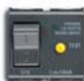
2CSE1309EL Interruttore automatico magnetotermico differenziale, 1P+N, C16 - 10mA, potere di interruzione 3kA
