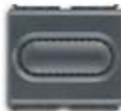
2CSE1319EL Suoneria/ronzatore, 12V - 50/60Hz, intensità sonora ronzatore 75 dB/1 m, suoneria 70 dB/1 m
