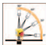
IP69K: Getti di vapore ad alta pressione da diverse angolazioni e rotazioni.
