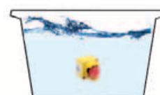
IP67: Immersione in acqua per 30 minuti alla profondità di 1 metro.
