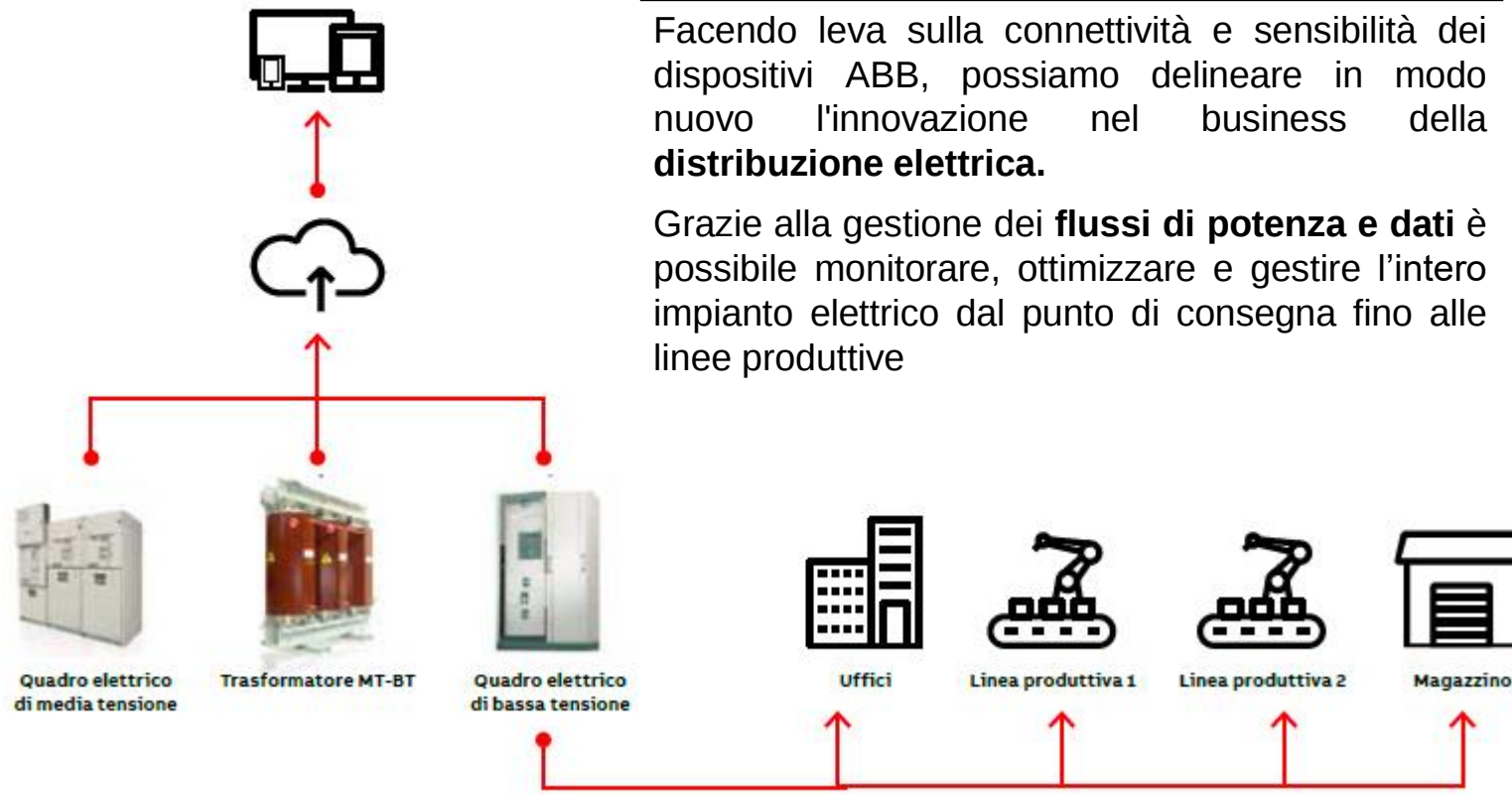
Schema di principio del Sistema ABB
