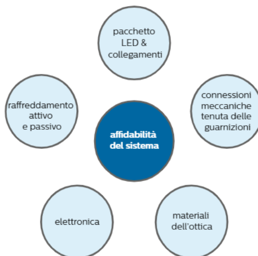
Figura 5 – Componenti critici in un apparecchio d'illuminazione a LED
