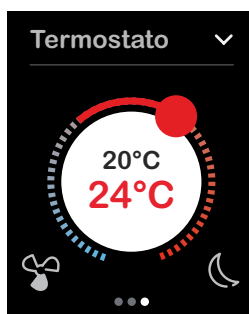
Controllo della temperatura nella modalità con cursore rotativo Il display mostra i valori di temperatura corrente e desiderata. La parte colorata del cursore diventa sempre più piccola man mano che ci si avvicina al set point desiderato.
