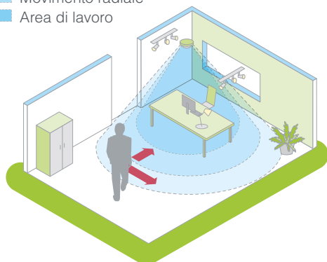
Figura 40. – Rilevamento di un sensore da soffitto
