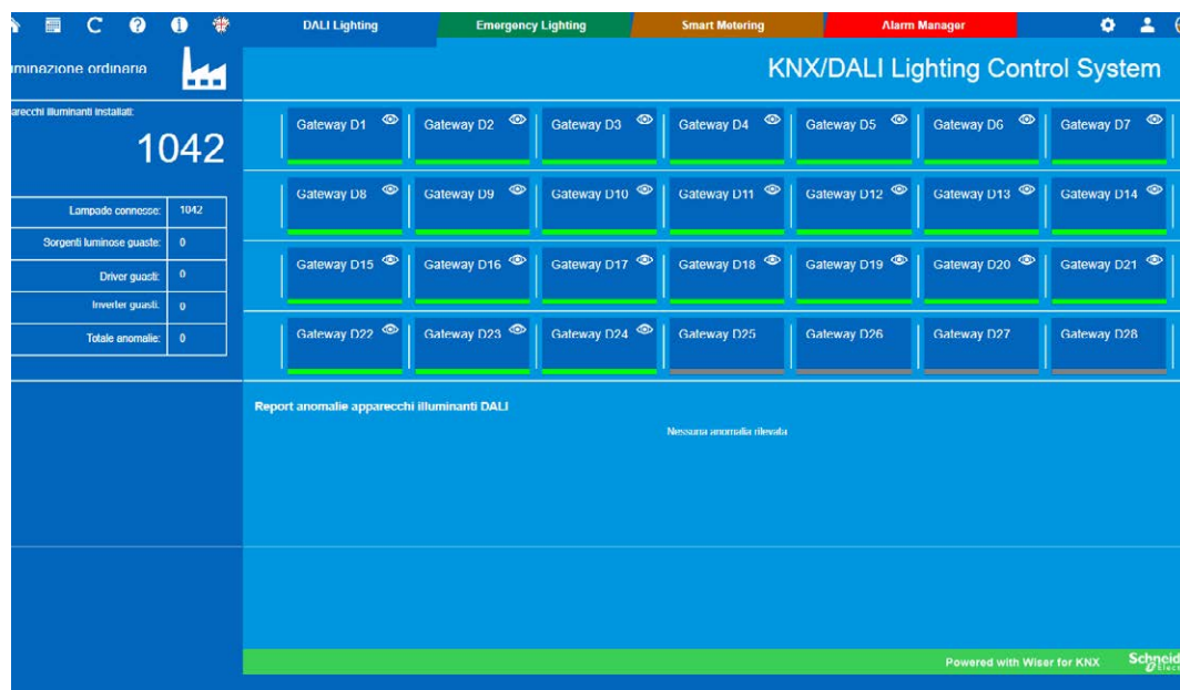
Figura 58. – Esempio di applicazione per la visualizzazione dei dati diagnostici DALI
