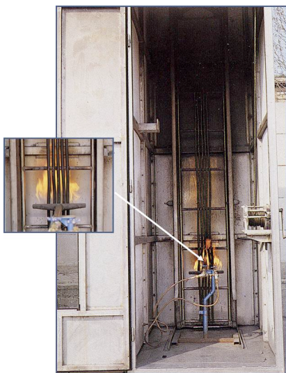
Prova non propagazione incendio
