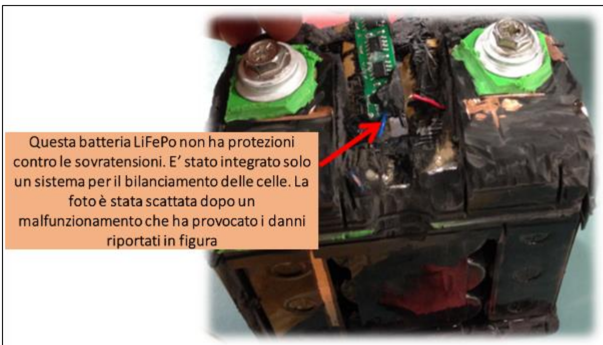
Figura 2 Esempio di Batteria Li-Ion con BMS per bilanciamento delle celle, ma senza protezione contro sovratensioni
