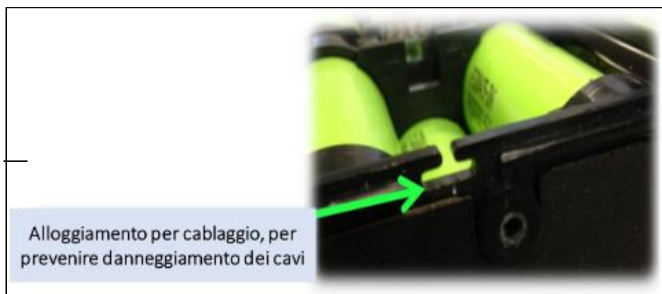
Figura 9 Integrazione meccanica di alta qualità e fissaggio del cablaggio
